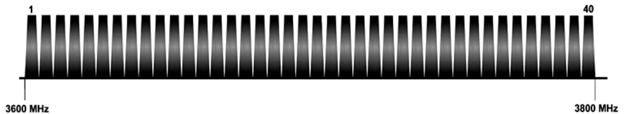
3. ábra A 3,7 GHz sáv blokk elrendezése (alapblokkok)
